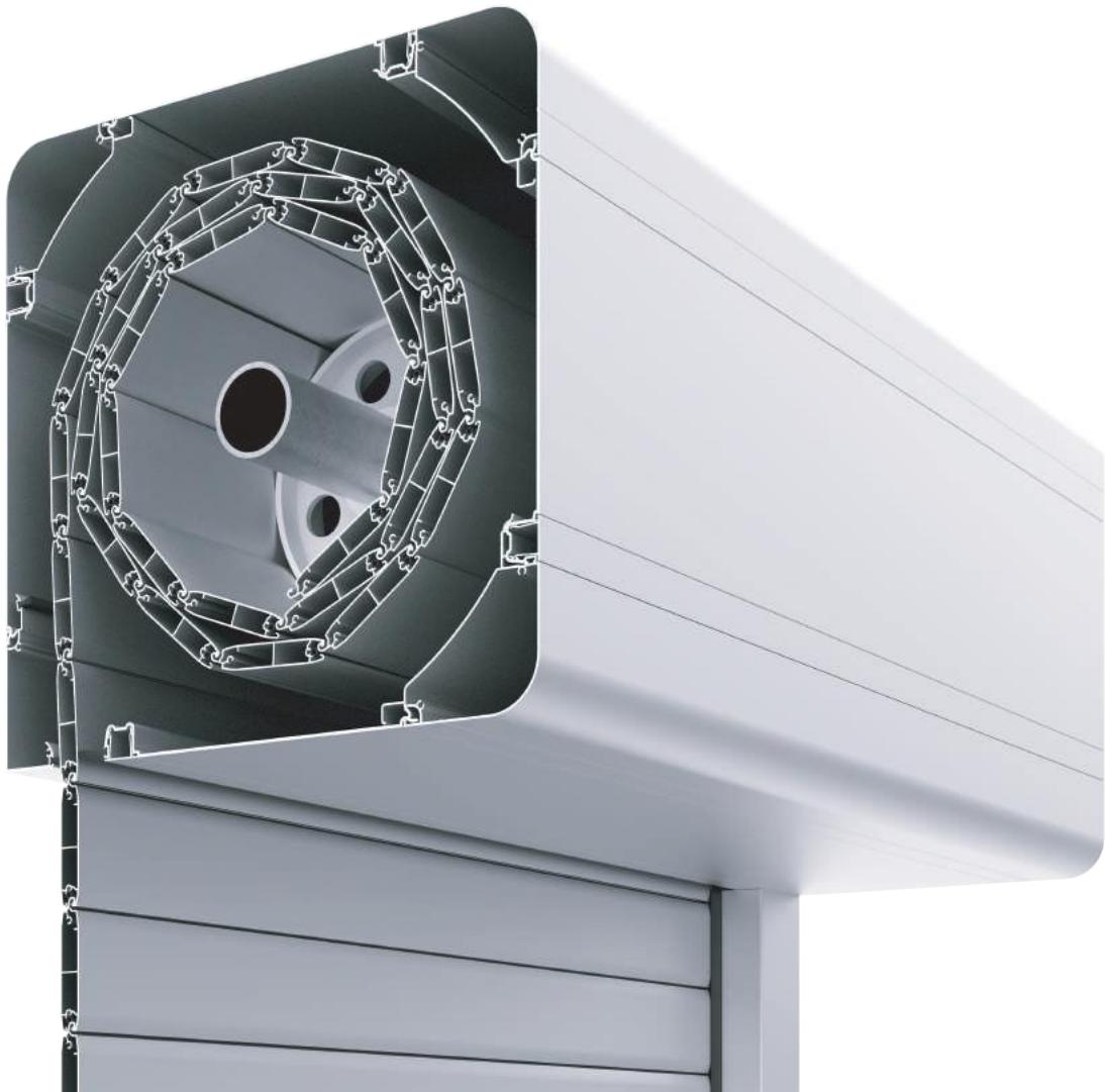
Basebox es un nuevo concepto de cajón para puertas enrollables, el primero formado únicamente por perfiles de extrusión, los cuales se engarzan unos con otros y se atornillan de forma oculta proporcionando al conjunto una mayor robustez, un sencillo y rápido sistema de montaje y un acabado homogéneo, ya que se evitan las diferencias de tono tan acusadas que se producen cuando se combinan diferentes materiales.
