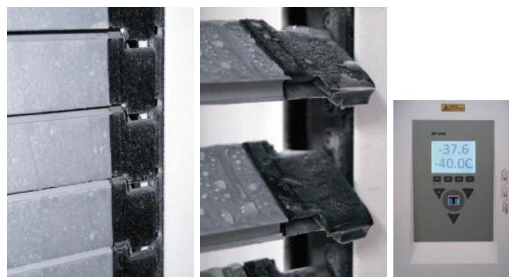
Test de temperatura extrema y hielo realizado en cámara climática.
